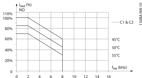
Ilustração 9.18 Derating da I_{out} para T_{AMB, MAX} diferentes do gabinete metálico tipos C1 e C2, utilizando SFAVM no modo de sobrecarga normal (sobretorque de 110%)
