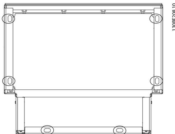
Ilustração 4.3 Pedestal nos pontos de montagem no piso
