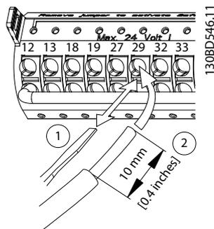
Ilustração 5.20 Conexão de fios de controle flexíveis
