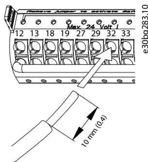
Ilustração 5.19 Conexão de fios de controle rígidos
