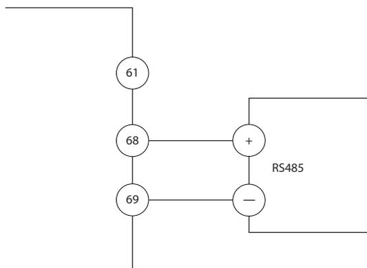
Ilustração 5.21 Diagrama da fiação de comunicação serial
